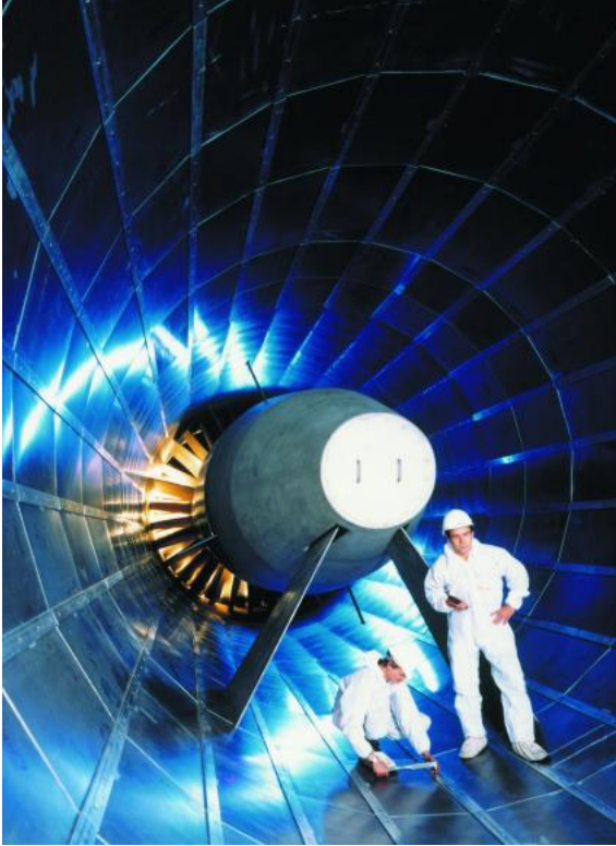
Stuttgarter Prüflabor testet Prototyp einer Kompressorschaufel für den European Transsonic Windtunnel
